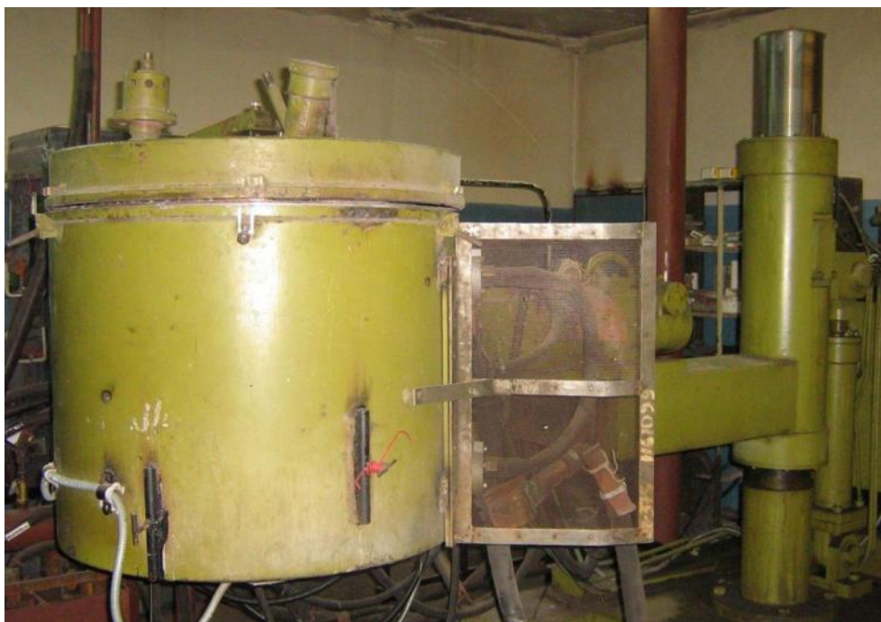
Рис. 3. Плавильный узел установки АМКЛ-300.
